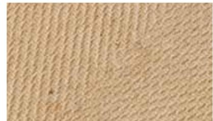
Finish-Oberfläche der STEICO<sup>top</sup> Dämmplatten
